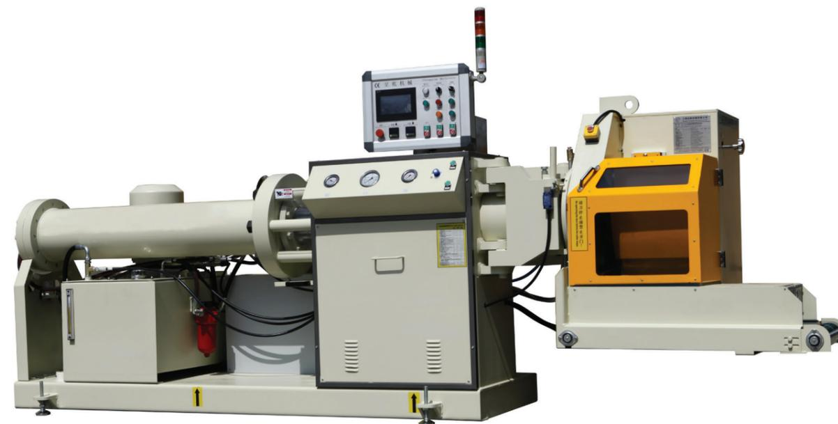
ся для поддержки сетки в качестве отвода материала. Можно фильтровать нитрилкаучук, бутылкаучук, фторкаучук, силиконовый каучук и другие резиновые смеси. Точность фильтрации достигает 300 mesh. По сравнению с процеживанием на шнековом фильтре, процесс процеживания не приводит к увеличению нагрева или включения явления опаления.
