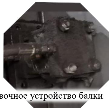
Блокировочное устройство балки
