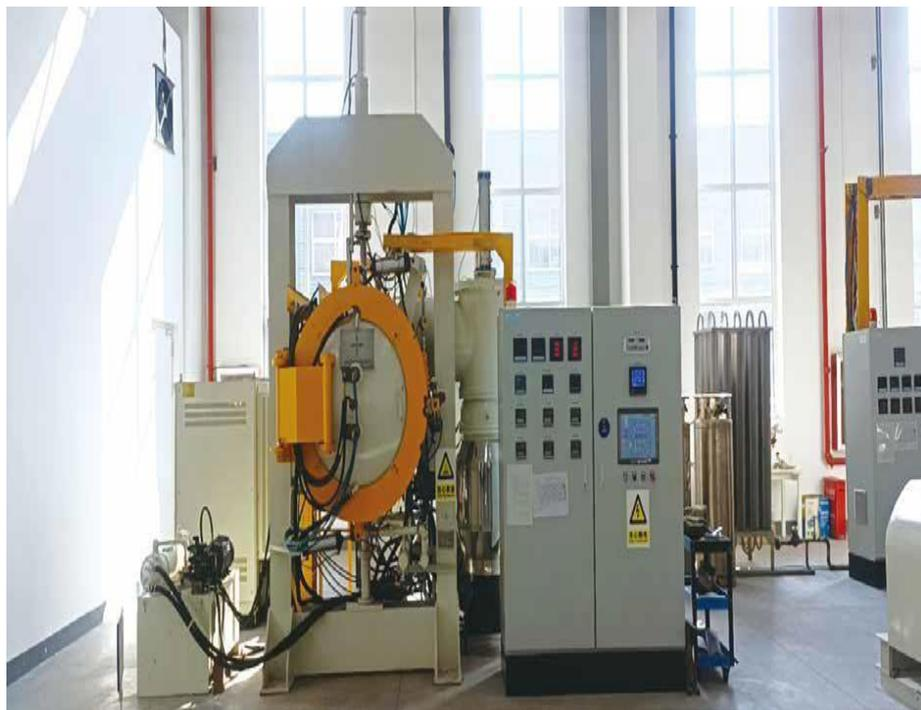
\*Серия ZKH - используется для обработки диффузионной сваркой цементированного карбида, эластичных сплавов, быстрорежущей стали и других деталей, а также может быть подвергнут термообработке, такой как вакуумная пайка, вакуумный отжиг или вакуумное старение.
