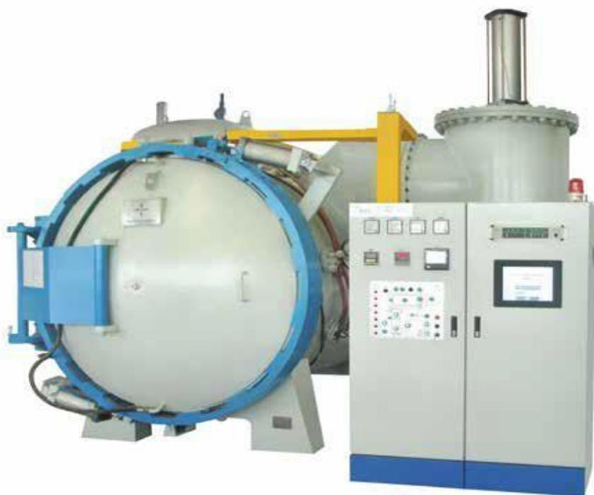
\***Серия ZGQ** -используется для газовой закалки под высоким давлением формовочной стали, инструментальной стали, быстрорежущей стали, нержавеющей стали и других легированных сталей, а оборудование имеет функции вакуумной закалки, вакуумного отжига, вакуумного спекания и частичной вакуумной пайки.
