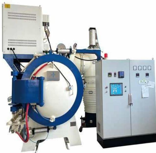
\*Серия ZTH - используется для вакуумного отжига конструкционной стали, инструментальной стали, быстрорежущей стали, нержавеющей стали, титанового сплава, высокотемпературных тугоплавких металлов, магнитомягких материалов и других цветных металлов, для достижения вакуумного яркого отжига, обработки отжигом для снятия напряжений.
