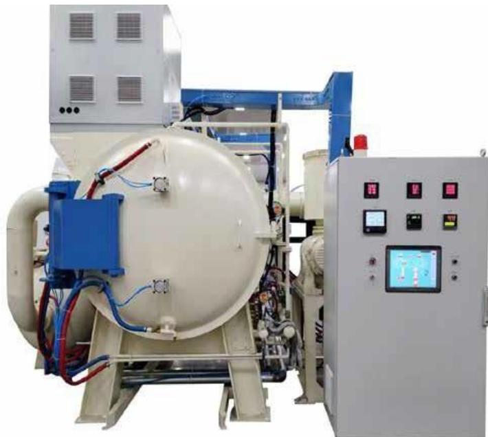
\* **Серия ZSJ** - Подходит для вакуумного спекания цементированного карбида, керамических материалов, порошкового литья под давлением, магнитных материалов, пористых материалов и порошковой металлургии.
