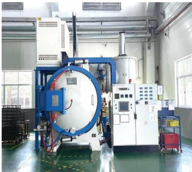
\*Серия ZHH- подходит для светлого отпуска после вакуумной закалки различных материалов, а также может быть использован для рекристаллизационного отжига и термообработки цветных металлов.
