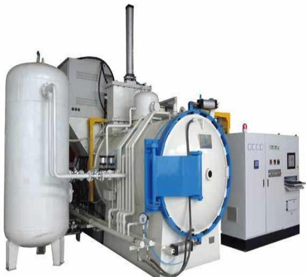
\*Серия ZYQ2 - используется для светлой закалки инструментальной стали, штамповой стали, подшипниковой стали, пружинной стали, нержавеющей стали и других материалов.
