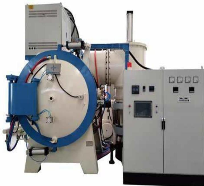
\*Серия ZQH - подходит для вакуумной пайки на основе никеля, меди, титановых сплавов, суперсплавов, цементированного карбида, цветных металлов, серебра, используемые изделия включают детали из нержавеющей стали, детали из титановых сплавов, алмазные инструменты.
