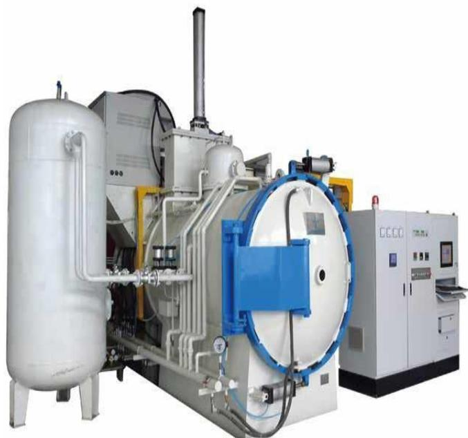
**\*Серия ZY (Q) 2-ST** - двухкамерная вакуумная печь для закалки в масле (газовой закалки) с функцией науглероживания под низким давлением, которая в основном используется для вакуумной закалки инструментальной стали, штамповой стали, подшипниковой стали, пружинной стали и других материалов, для вакуумной науглероживающей и упрочняющей обработки стали и другие детали из низкоуглеродистой легированной стали.
