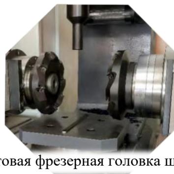
Чистовая фрезерная головка шпинделя
