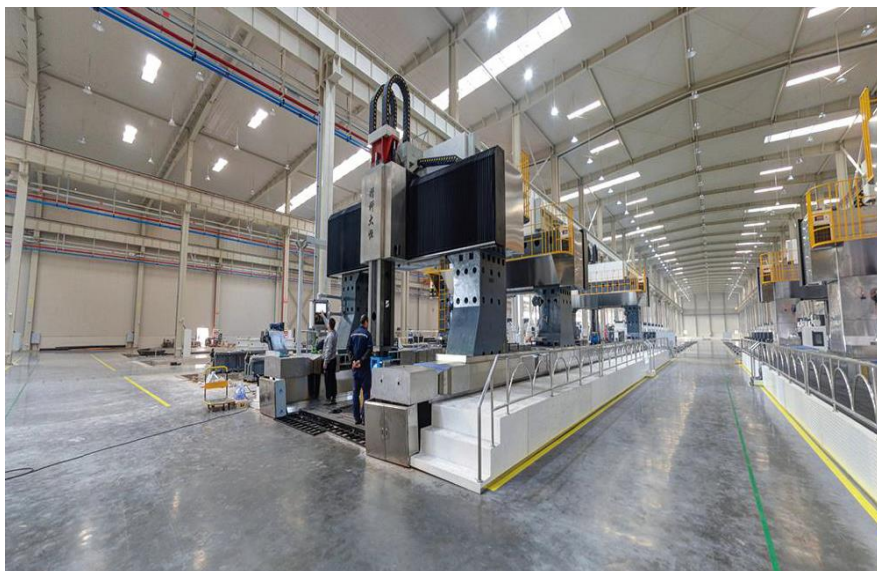
Портальный фрезерный станок с ЧПУ с подвижной колонной, портальный обрабатывающий центр в сборе (оптический станок)
